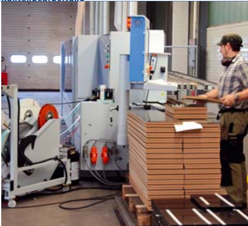
Ein Mann genügt: Die laserTec-Maschine, ausgestattet mit automatischer Teilerückführung, fährt bei Schuon mit einem Vorschub von 18 m/min (BM-Fotos: Christian Närdemann)
