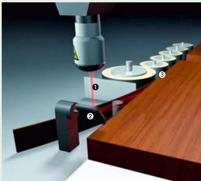
Das Funktionsprinzip: 1 Homag setzt bei laserTec auf einen Diodenlaser 2 Der Laserstrahl wird durch einen oszillierenden Spiegel auf das Kantenband umgelenkt und schmilzt die Laseraktivschicht 3 Anpressen des Kantenbandes auf das Werkstück
