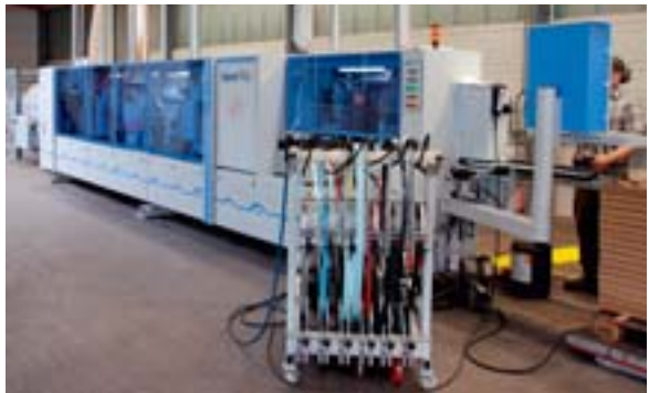
Rückseitige Teilerückführung für Ein-Mann-Bedienung (oben); Kompakt und unscheinbar: laserTec-Maschine bei Schuon (unten)
